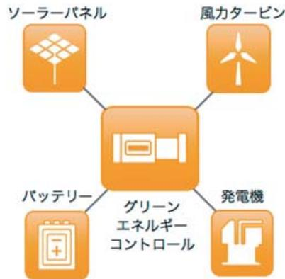
オフ-グリッドサイトソリューションでは、発電機の運用時間と燃料消費量を10分の1(2キロリットル/年)に削減するだけでなく、1サイトあたりのCO<sub>2</sub>排出を年間5トン削減します。ソーラーパネルと風力
